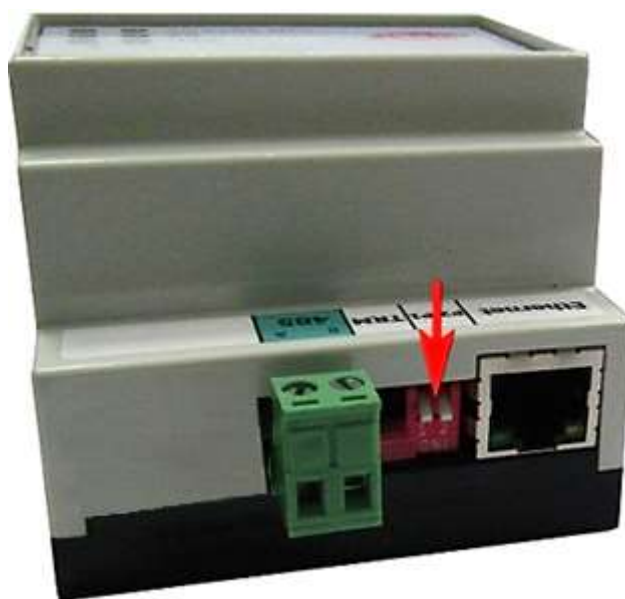
Рисунок 3 – Перевод движковых переключатели в положение ON
