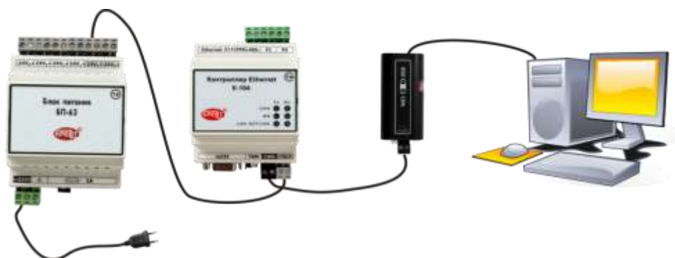
Рисунок 4 – Подключение K-104 к ПК по интерфейсу CAN-BUS
